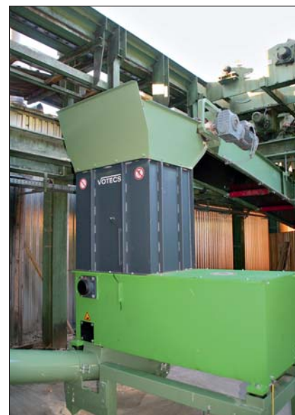
... Reste werden dem neuen Zerkleinerer zugeführt. Das Holz landet mit den Spänen aus dem Sägewerk in einem separaten Lager.
